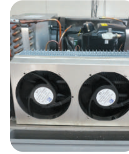
Ekstra Kuvvetli Dayanıklı Fanlar Yüksek Hava Akışı Strong Fans with maximum air speed
